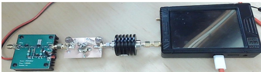
Figure 20. Le filtre passe-bas est connecté à la sortie de l'amplificateur de puissance.
