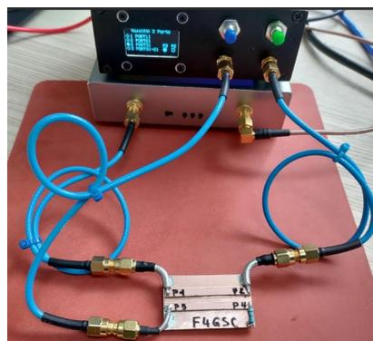
Figure 9. Montage de mesures ROS, S21 et S31.
