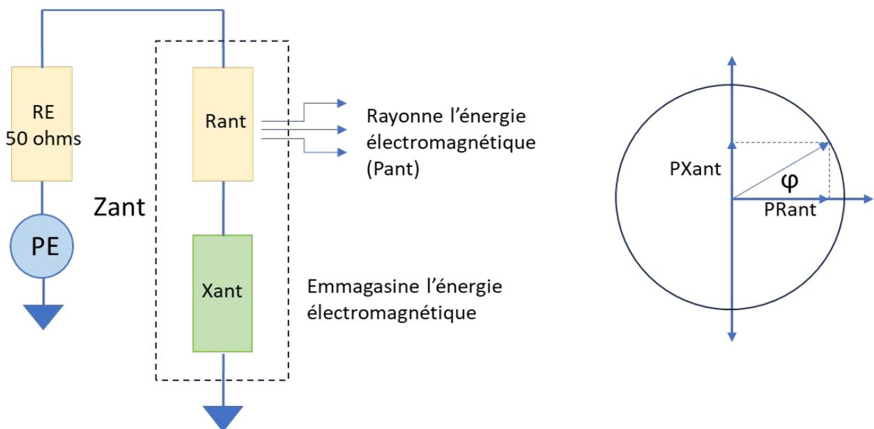
Seule la résistance de rayonnement ( $R_{ant}$ ) propage ou reçoit l'énergie électromagnétique, qu'il y ait adaptation ou non.
