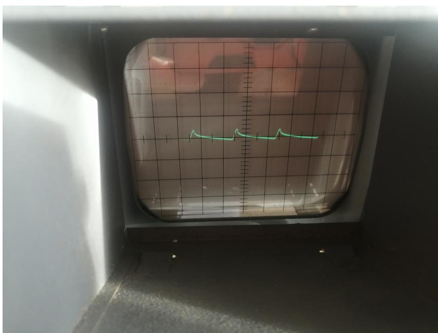
Aux bornes condensateurs , plus on charge la sortie de l'alimentation (en ampères) plus l'ondulation augmente.
