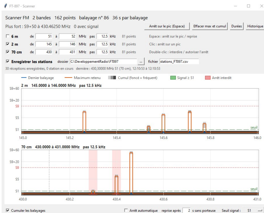
Figure 1. L'affichage de deux bandes et des fréquences reçues. La troisième bande n'est pas utilisée : elle n'est donc pas cochée.
